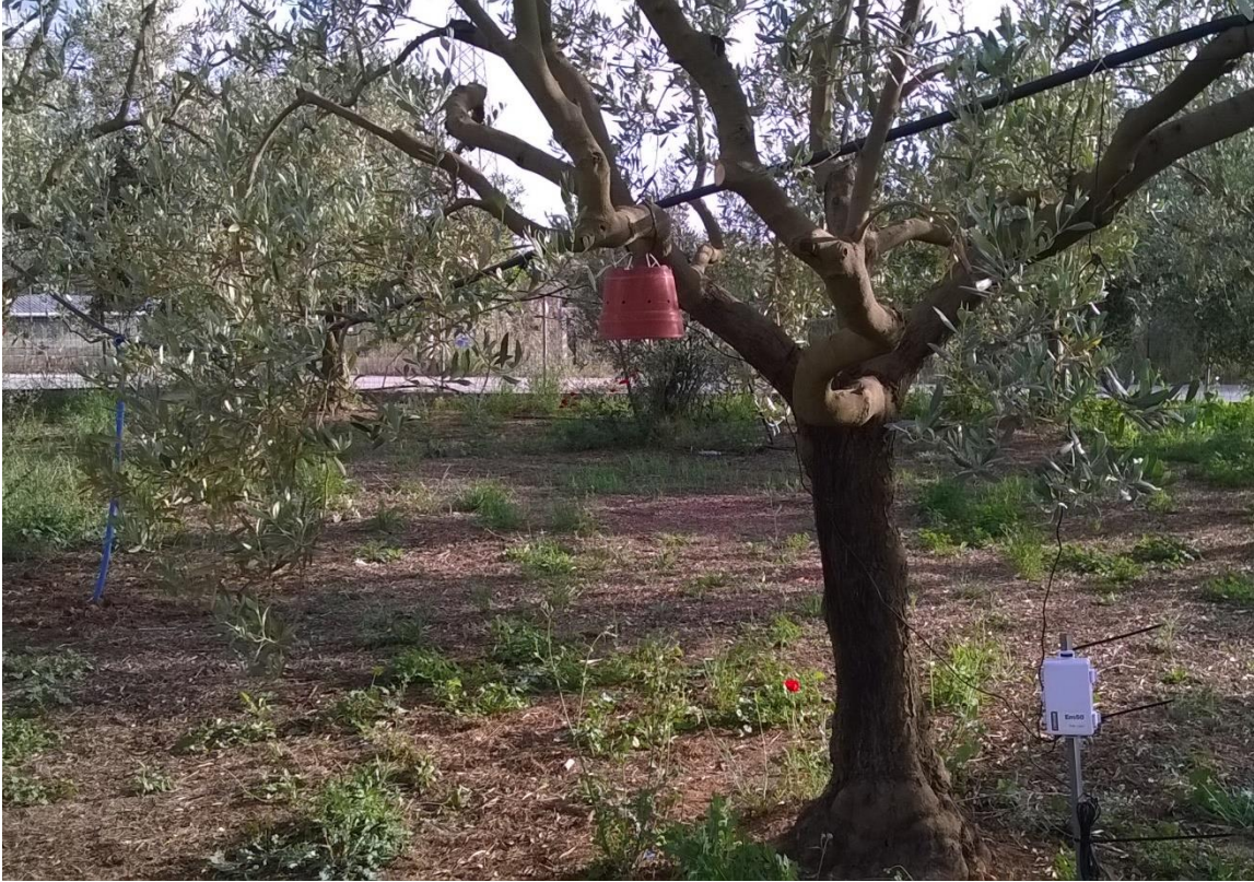
Εικόνα 9 Εγκατεστημένος αισθητήρας μικροκλίματος σε προστατευτικό κάλυμμα. Φαίνεται το σημείο τοποθέτησης τους σε κλαδί δέντρου σε ύψος περίπου 2 μέτρα από το έδαφος και κοντά σε αισθητήρες εδάφους (στα δεξιά της φωτό φαίνεται το άσπρο κουτί του καταγραφικού στο οποίο συνδέονται τα καλώδια των αισθητήρων, στο αριστερά άκρο της φωτό φαίνεται ο πλαστικός μπλε σωλήνας που καλύπτει το καλώδιο του αισθητήρα εδάφους).
